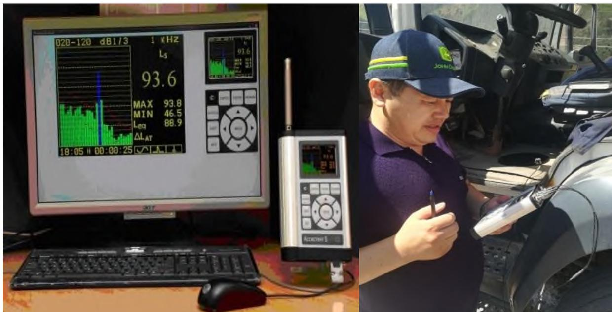
**Рис 2. Процесс измерения шума, вибрации с помощью «АССИСТЕНТА» и обработка результатов с помощью компьютера.**
