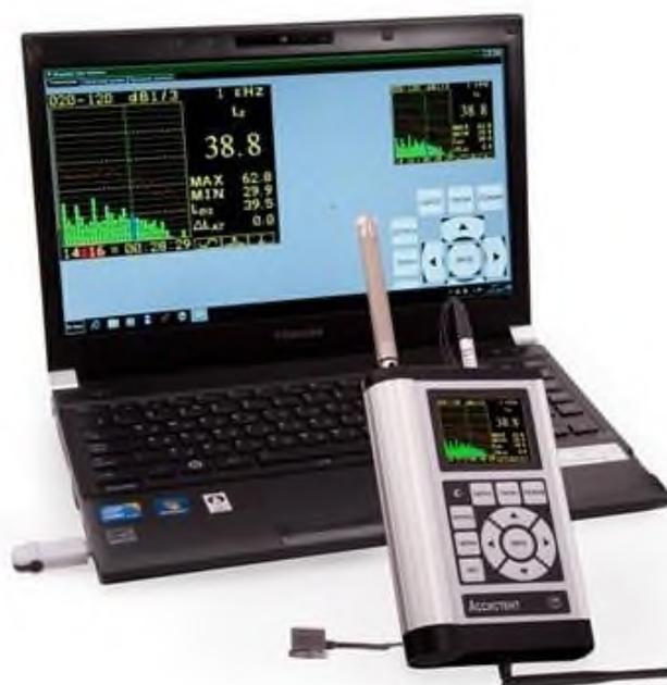
**Рис 1. Прибор для измерения и анализа шума и вибрации «АССИСТЕНТ»**
